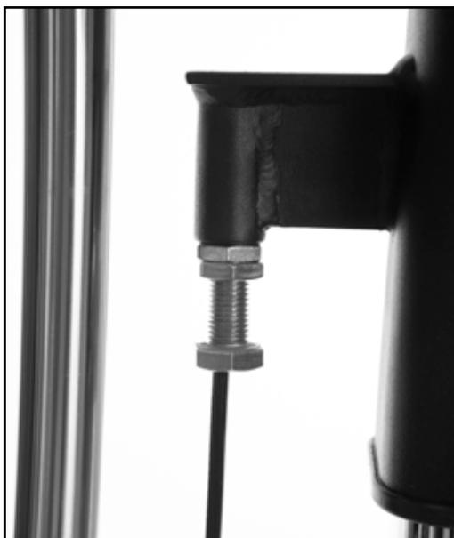
Der Seilzug muss optimal gespannt sein. Sie haben die Möglichkeit die Spannung an den Einstellschrauben zu justieren. Erhöhen Sie die Spannung soweit, bis sich der Gewichteauswahlstab anfängt zu heben. Die Einstellschraube muss mindestens 0,5cm eingedreht sein. Ist die optimale Seilzugspannung erreicht, dann sichern Sie diese Position mit dem Festdrehen der Kontermutter.
