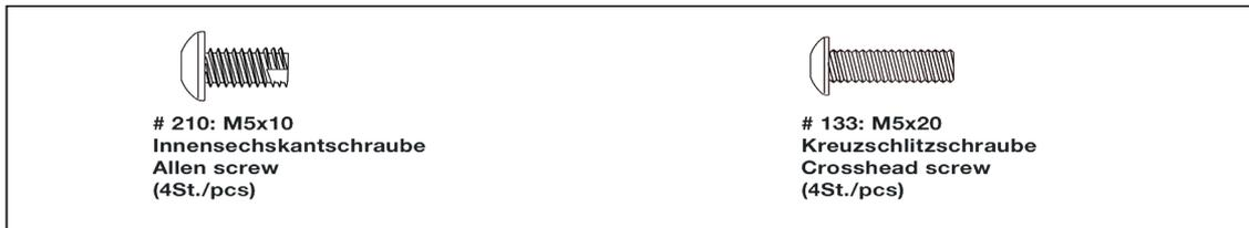
1. Montieren Sie die Computerhalterung (194) mit vier M5x10 Innensechskantschrauben (210) an der Rückseite des Computers (28).
